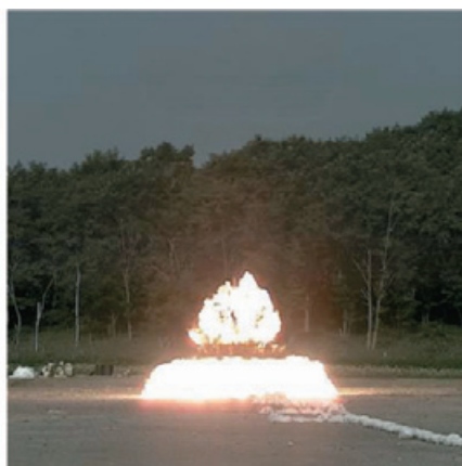
図 TNT爆薬の爆発状況 (経済産業省主催の平成18年度火薬類保安技術実験の結果)
